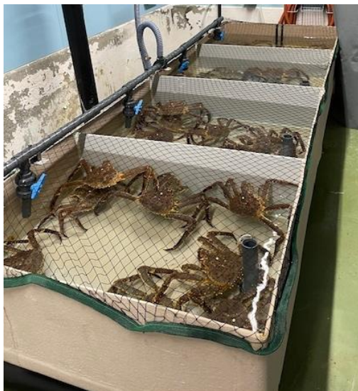
Bilde 2 Forsøksoppsett for AP3. En av de to stk. 1 x 3 m renne delt i 4 kamre med eget inn og utløp med 8 krabber per kammer. Lysnivået er noe høyere på bildet enn i forsøksperioden.
