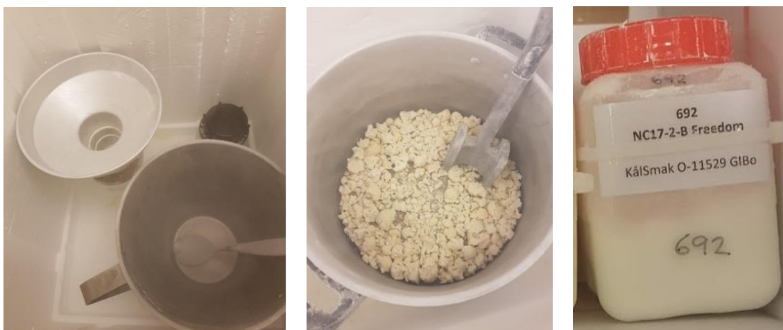
Bilder over og nedenfor: Utstyr til prøvepreparering av kål. Kål sjokkfryses i flytende nitrogen, bankes til mindre biter og overføres til bokser med skrulokk.
