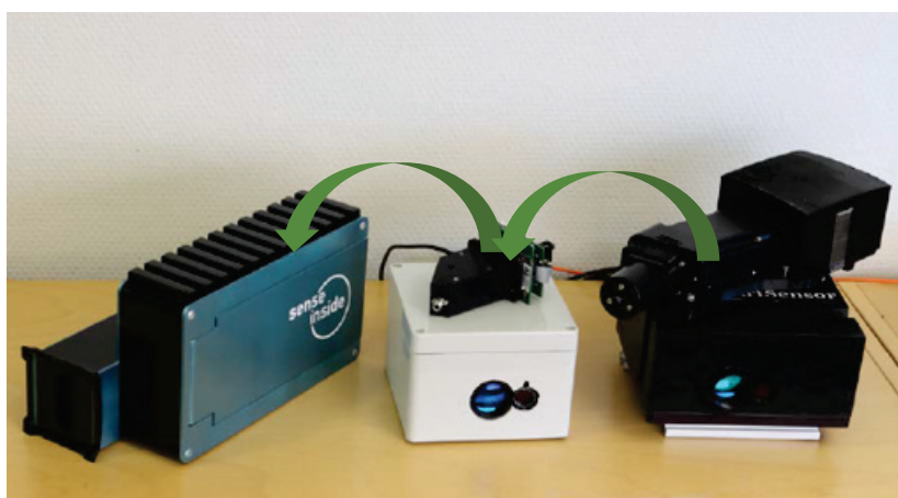
Figur 13 Første prototype til høyre. Andre versjon i midten – den er vesentlig mindre. Den kan bygges inn i et håndholdt instrument som det til venstre (som er en foreløpig modell å vise sluttbrukerne den mulige størrelsen).
