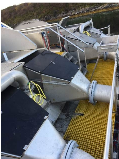
Figur 2 Utløpet av Optilice blir dekket og mørklagt for å hindre slagskader og at fisk hopper ut av systemet
