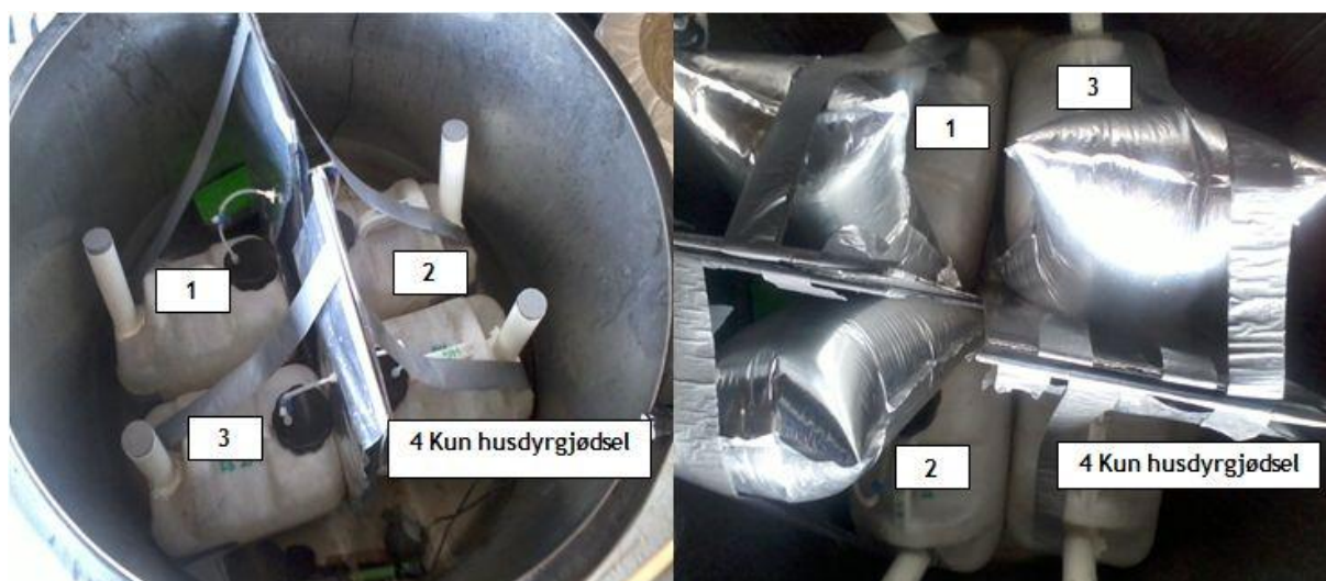
Figur 7 Småskala biogassreaktorer ved oppstart av forsøk (venstre) og etter 9 dager med innmating av fiskeslam og storfe gjødsel (høyre). Reaktorer 1,2 og 3 tilsatt fiskeslam og reaktor 4 tilsatt kun storfe gjødsel.
