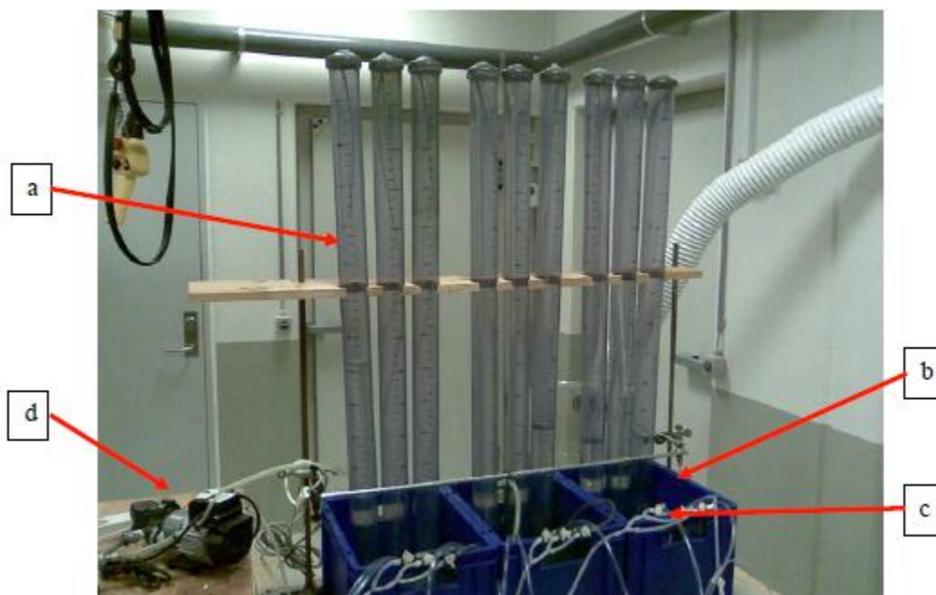
Figur 4 Metode for bestemmelse av gass-volum, (a) sylindere, (b) vannkar, (c) slange for biogass, (d) vakuumpumpe.
