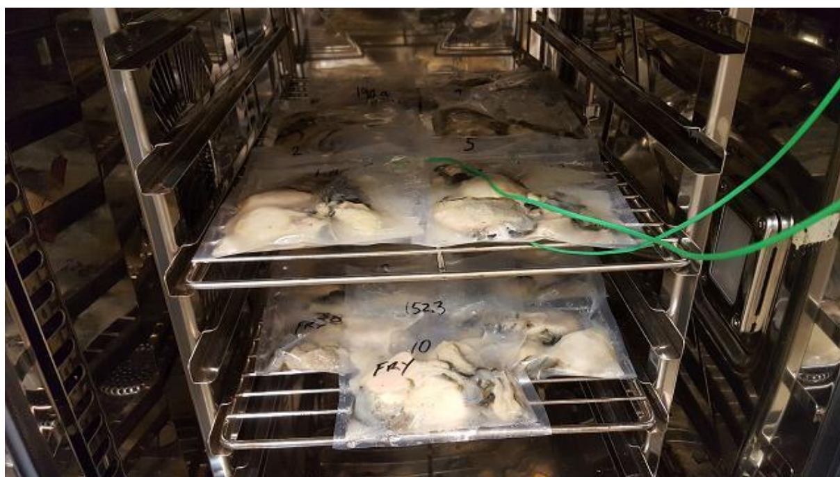
Figur 4 Det ble foretatt kjernetemperaturmålinger i poser med skjellprøver under koking i kombidamper
