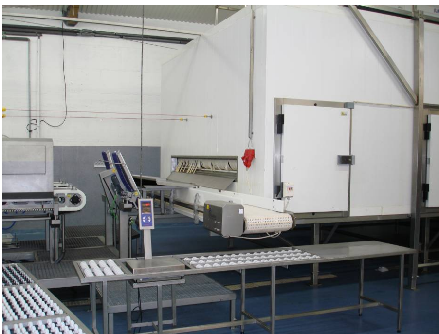
Figur 10. Skinnkjølerens utmatingsende. Båndene for overføring av filetene til de to skjære- og skinnelinjene er vippet opp i nesten vertikal stilling. Filetskanneren vises helt til venstre i bildet.
