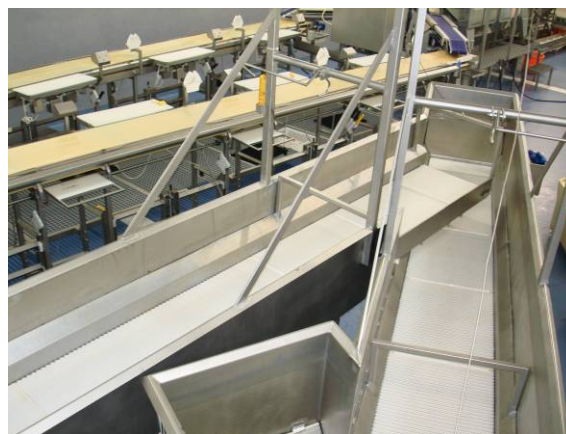
Figur 5. Overgang mellom første og andre transportbånd i filetkjøler sett fra utmatingsenden.
