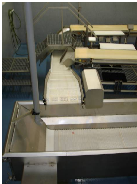
Figur 3. Overføring av filet fra trimmebord til filetkjøler. Enden av det doble trimmebåndet er synlig i bakgrunnen, innmatingsdelen av filetkjøleren (issørpekaret) i forgrunnen.
