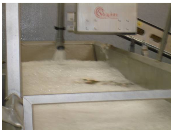
Figur 4. Rør for tilførsel av issørpe til filetkjøleren, i siste del av tømme-fasen.
