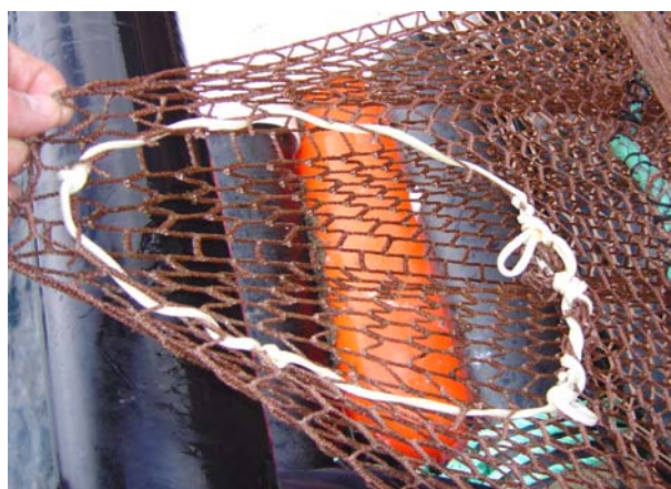
Figur 5. Hull i notposen hvor det var mulig for fisken å svømme inn eller ut. Hullet er ca 25 cm høyt og ca 15 cm bredt.
