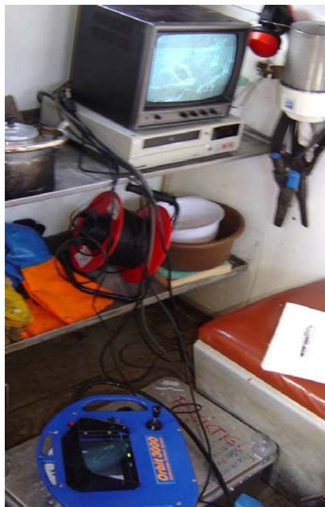
Figur 3. Oppsett i båt for opptak og observasjon av fiskens aktivitet i merden
