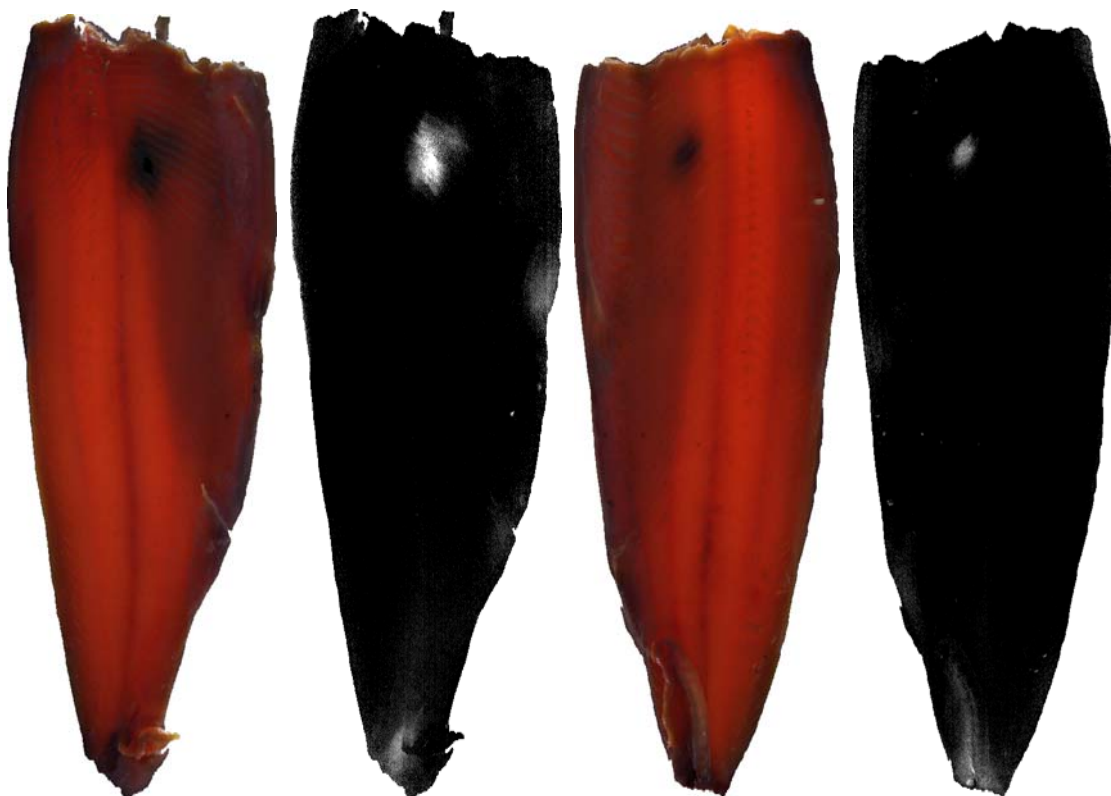
Figur 2 Kunstig fargebilde av to laksefileter med tilhørende analyseresultat for melanin til høyre. Melaninflekken i fileten til venstre gikk helt ned til skinnen, mens i fileten til høyre var flekken kun i overflaten. Bildene er ikke kalibrert for korrekt fargegjengivelse.
