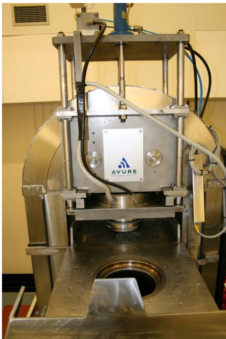
Bilde 1 Nærbilde av stempel og trykkammer til venstre. Til høyre størrelsen på høytrykkssystemet som ble brukt under denne testen (AVURE , QFP-35L-600)
