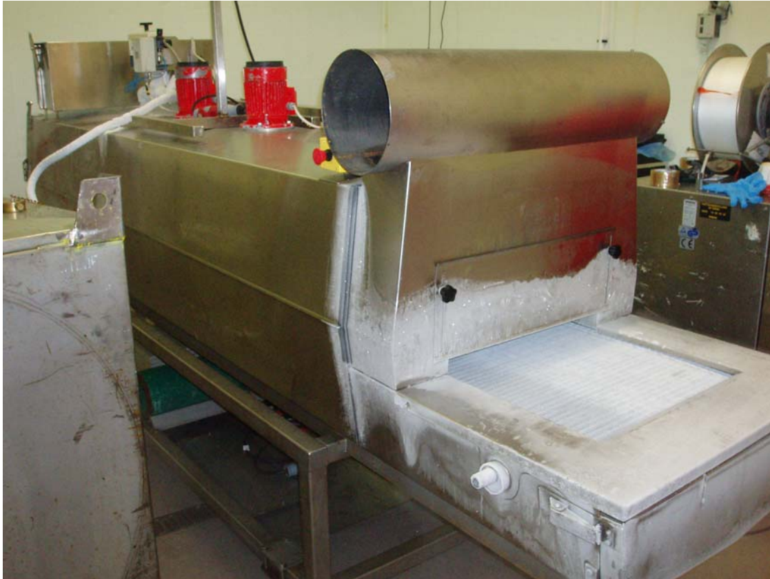
Bilde 2 Nitrogenbåndfryser innstilt på -60\text{ }^{\circ}\text{C} og 4 minutter holdetid.
