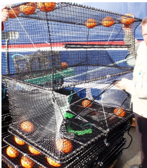
Bilde 8 To-kammerteina som ble brukt i forsøksfiske etter kreps i Nordsjøen.
