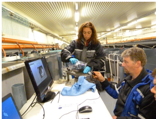
Figur 1 Bilde som viser samtidig lesing av PIT-tag og irisskanning. Laksen ligger i et stativ (slede) med åpning for hodet/øyet
