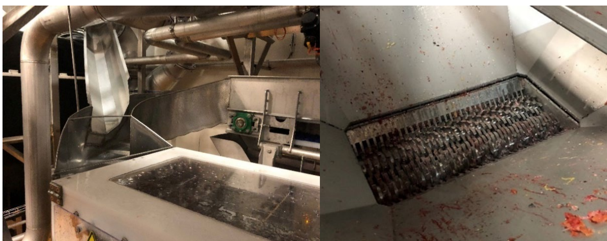
Figur 3 Venstre bilde: Innmating av fisk til Stansas destruksjonsbedøver, innmating til venstre er for småfisk fra avsilingskasse, mens høyre er fra manuell utsortering fra slakteriggen. Høyre bilde: Viser en GS 150 tannkvern.
