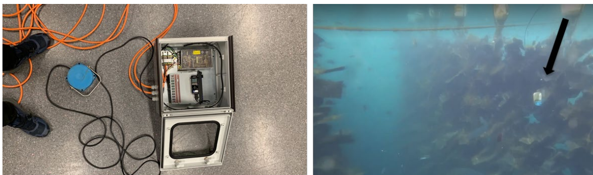
Figur 11. Styringsskap med undervannshøytaler (venstre) og plassering av høytaler i rensefisk-skjul (høyre).
