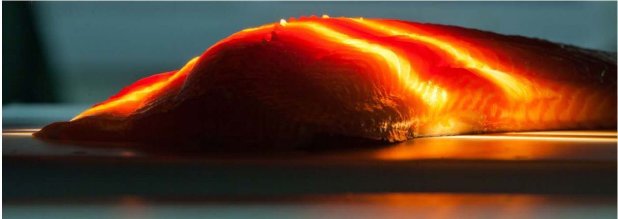
Figur 1 Laksefilet med projiserte lyslinjer som viser interaktansoppsettet. Spektrografen registrerer hvor mye lys som kommer ut av fileten midt mellom lysstripene.
