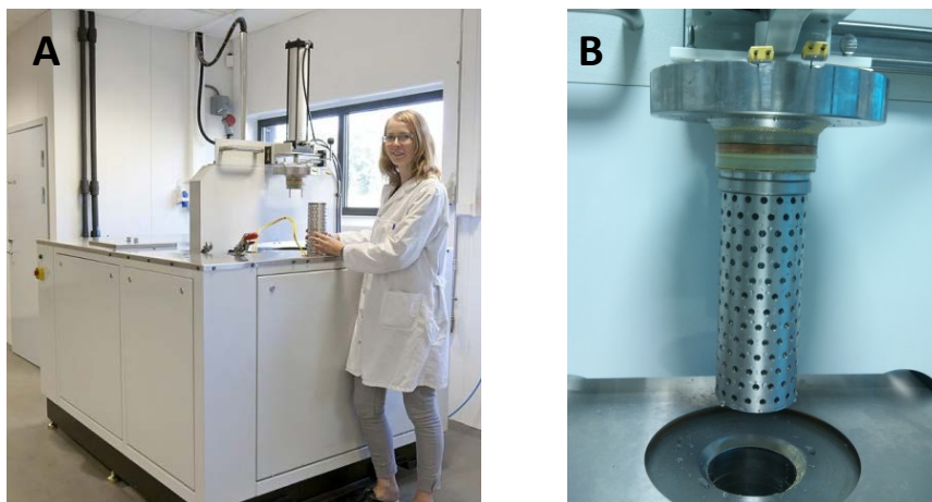
Figur 2 Utstyr for høytrykksprosessering (A) med nærbilde av kammer for plassering av produkter for høytrykksprosessering (B). Kammeret er på ca 2 L.
