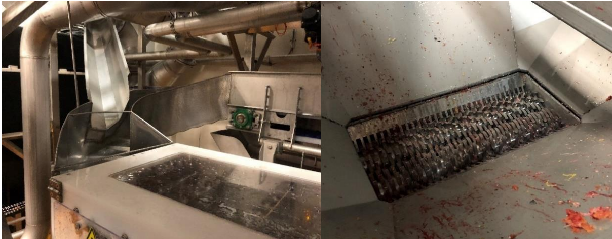
Figur 1 Venstre bilde: Innmating av fisk til Stansas destruksjonsbedøver, innmating til venstre er for småfisk fra avsilingskasse, mens høyre er fra manuell utsortering fra slakteriggen. Høyre bilde: Viser en GS 150 tannkvern
