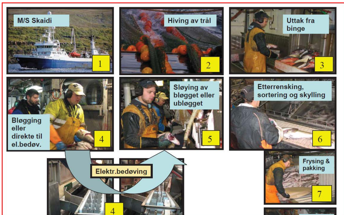
Figur 15 Fangstbehandling om bord i tråleren (steg 1 til 7). Etter at trålen blir halt opp på dekk blir fisken sluppet ned i to mottaksbingjer (uten vann). Der blir den mellomlagret til den blir bløgget og sendt til tørrutblødning (uten vann) før maskinell sløyning og hodekapping, manuell etterrensing, sortering og skylling. Alternativt går fisken direkte til sløyemaskin (uten bløgging). Elektrobedøver ble plassert ved mottaksbingje før bløgging som et alternativt trinn i Prosesseringen (SINTEF Fiskeri og havbruk).
