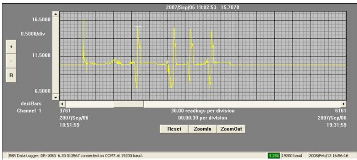
Figur 5 Trykkprofiler ved bruk av vakuumpumper. Til forskjell fra mammutpumper er det et tydelig trykkfall (vakuum) i sugesekvensen (Midling et al., 2008).
