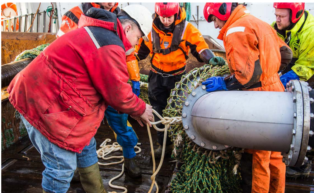
Figur 20 Festing av codend til pumpeslangen (Foto: © NOFIMA)
