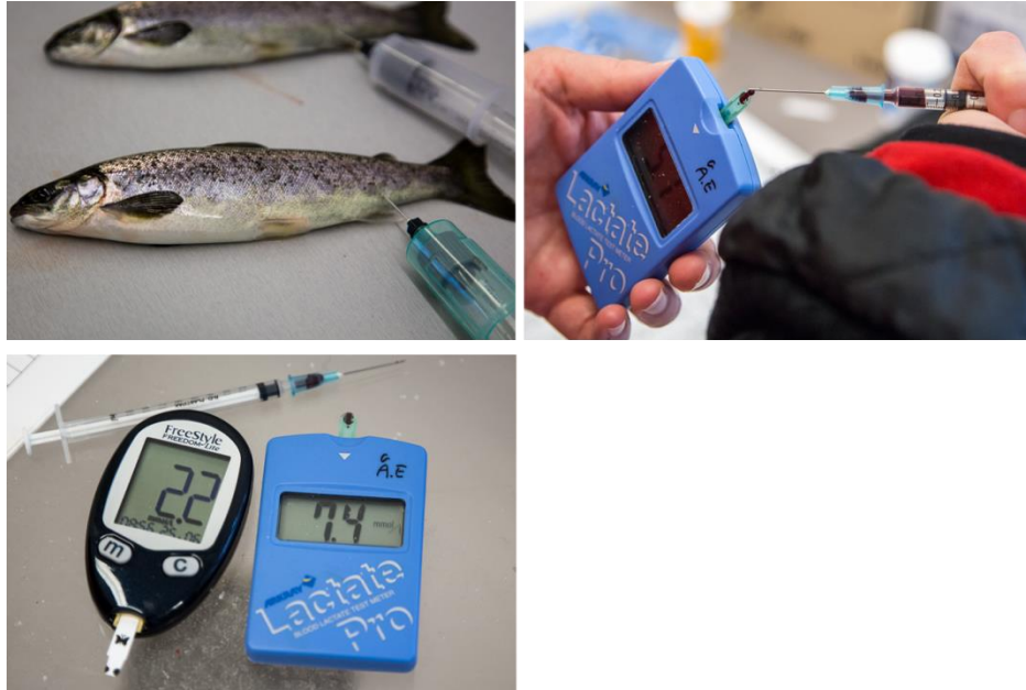
Figurer Prøvetaking med vakuutainers i haleregionen (øverst venstre). Applisering av blod i en LaktatPro (øverst høyre), FreeStyle til glukosemålinger og LaktatPro til laktat målinger
