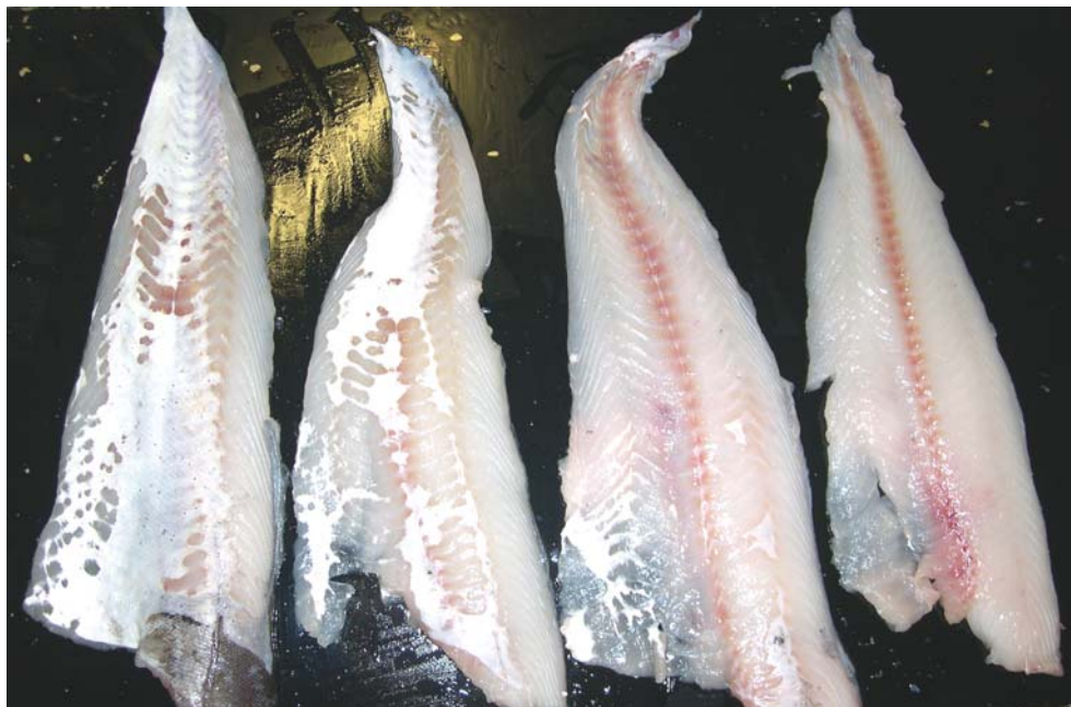
Bilde 7. Eksempler på hysefilet som er skinnet med ulik skinnedypde på en FDS 105.
