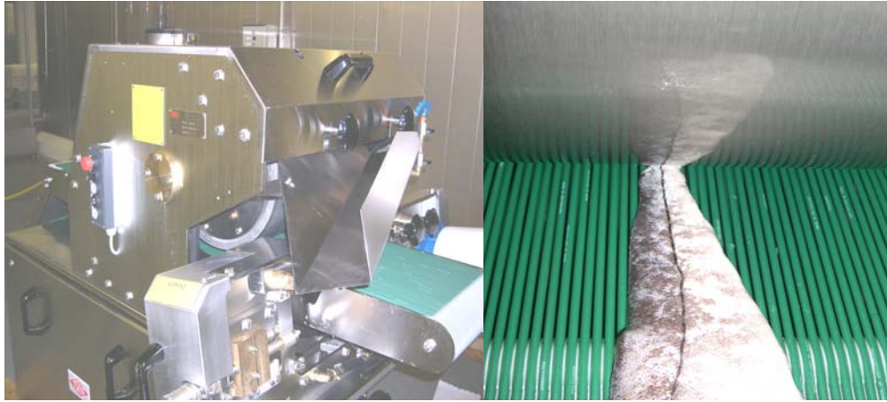
Bilde 3. Trio skinnemaskin type FDS 105, produsert år 2003. Til høyre vises en filet på vei inn i maskinen. Fileten legges på elastiske snorer med kjøttssiden ned slik at skinnet presses opp mot frysetrommelen.
