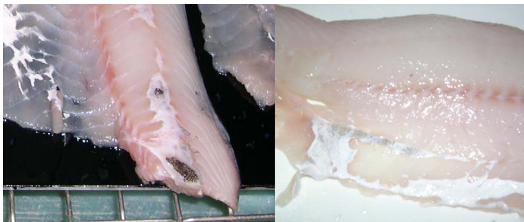
Bilde 8. Typiske skinnefeil under skinning av hyse i FDS 105. Til venstre rester av skinn ved ørebeinfestet. Til høyre rester av skinn i buken.
