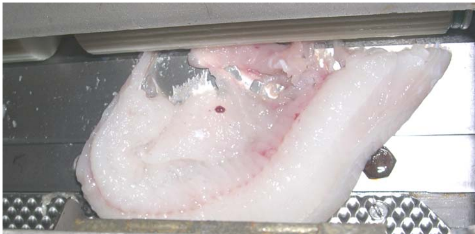
Bilde 4. Hysefilet som er heftet fast på vei ut av Baader 51 skinnemaskinen. Spor og bukstykker er utsatt for rivning, samtidig som resten av muskelen belastes og kan spalte.
