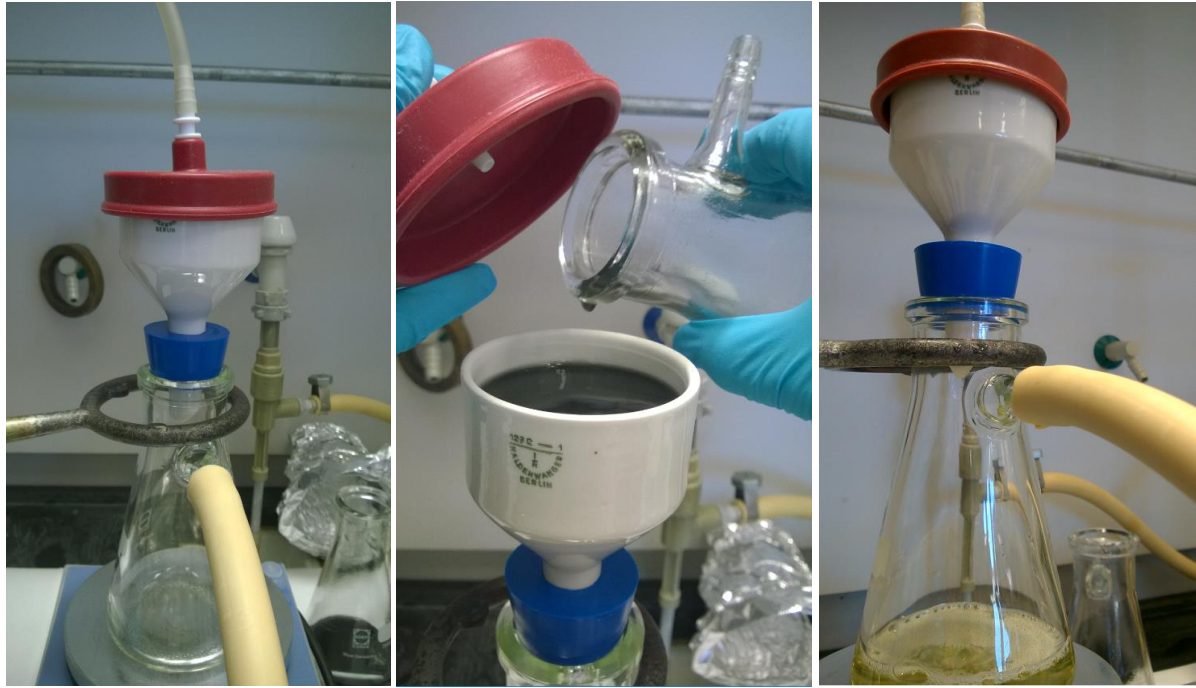
Figur 2 Apparatur for filtrering av blekjord
