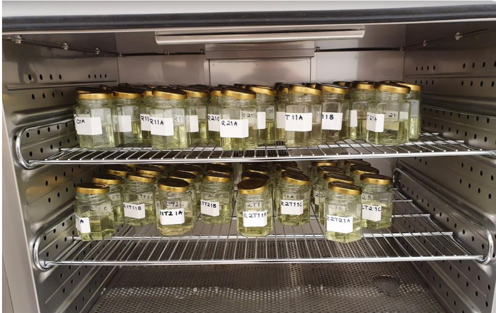
Figur 2 Akselerert lagringsforsøk av oljeprøver i varmeskap.
