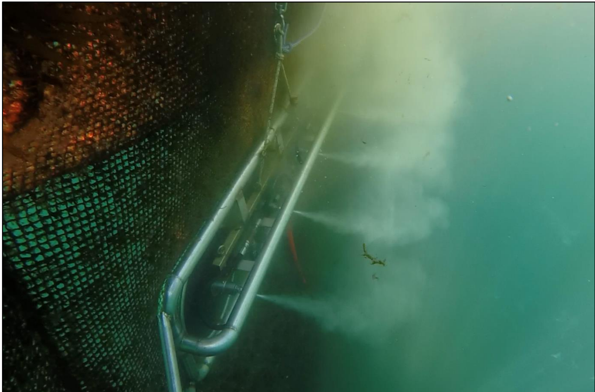
Figur 2.2.3-2. Eksempel på en notrengjøringsrigg fra AKVA med 4 rengjøringshoder under bruk. (Foto gjengitt etter tillatelse av N. Ribeiro, 2016).
