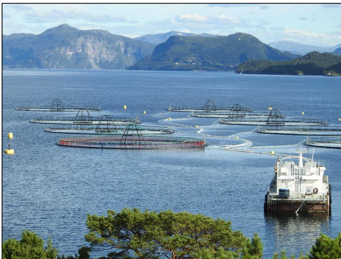
Figur 1.9-1. Sentralfôringsystem med fôringsrør som går fra en sentral fôrflåte til kommersielle oppdrettsmerder av regnbueørret. (Foto Ola Sveen, Svanøy Havbruk AS)
