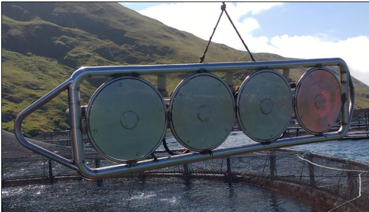
Figur 2.2.3-1. Eksempel på en notrengjøringsrigger fra AKVA med 4 rengjøringshoder. (Foto gjengitt etter tillatelse av N. Ribeiro, 2016).
