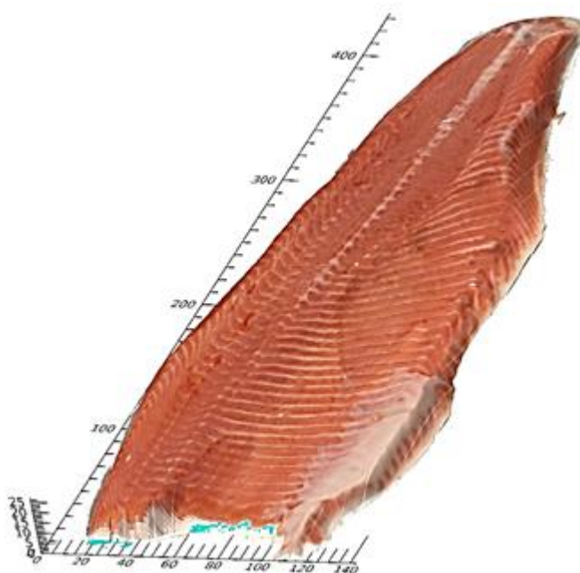
Bilde 4 Viser regnbueørretfilet klar for maskinell fargemåling (til venstre). Bildet til høyre viser 3-D scannet filet. Fargen på filetene (n=8) den 26. november ble målt ved hjelp av diffus reflektansspektroskopi.
