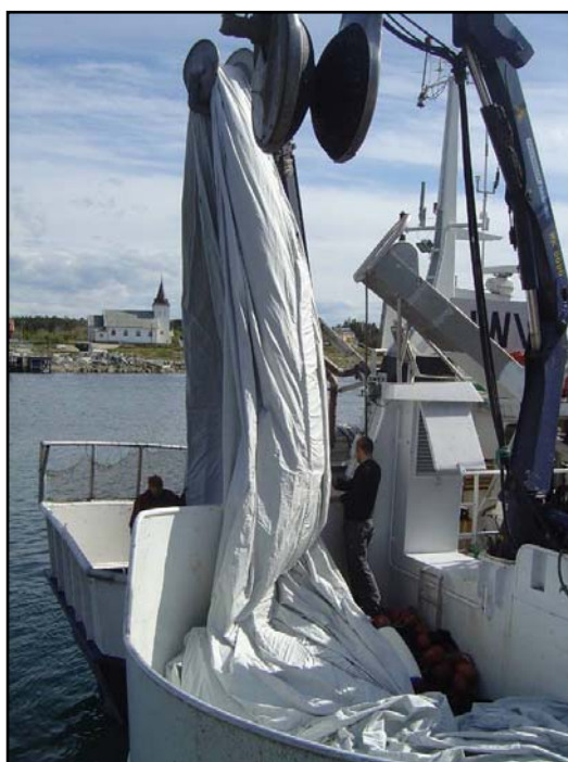
Bilde 11 Bildet viser plassering av pose på 280 m 3 når den legges i notbingen til M/K Sjonglør.
