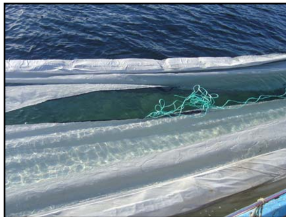
Bilde 2 Ved oppstart igjen sprakk slepeposen i hele posens lengde fra skaden ved glidelåset. Fisken som var i posen da ble mistet.
