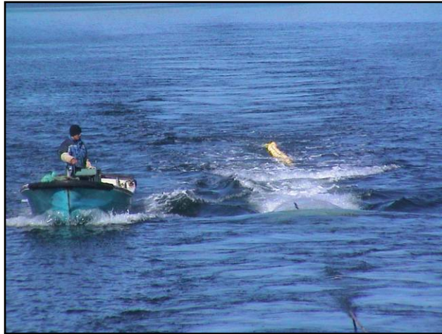
Bilde 12 Slepet starter etter at bakre åpning er justert i forhold til hvor stor fart man ønsker inne i posen. Posens funksjon inspiseres her fra lettboat.
