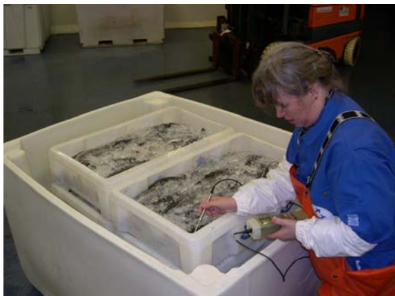
Bilde 4 Transporten av seifiletene gjøres klar og temperaturen måles i filetene før avreise fra Stokfisk AS til Brødrene Aarseth AS.
