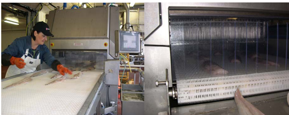
Bilde 5 Til venstre vises seifiletene på vei inn i og til høyre vises filetene på vei ut av injeksjonsmaskinen.
