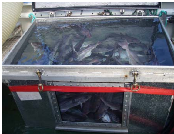
Foto fra rigging av forsøkskar på dekket hos M/K Kildin. Til venstre de to 800-liters karene, til høyre er ett kar åpnet for uttak av forsøksfisk.
