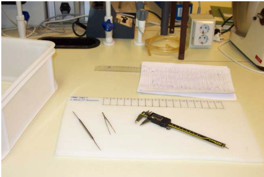
Bilde 1. Brett og verktøy som ble benyttet under plukking og posisjonsbestemmelse av tykkfiskbein i filet.
