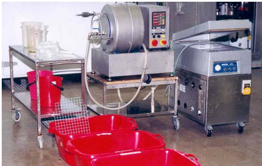
Figur 5. Vakuumbehandlingen ble utført i en Scanro Vakuumbrommel, volum 30 liter. Trommelen ble ikke rotert under vakuumbehandlingen og ble derfor løftet ut av styrings-braketten og plassert på et flatt underlag med lokket og sugestussen opp.
