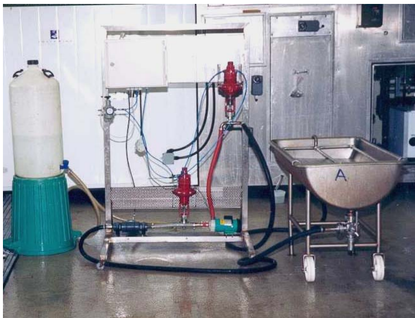
Figur 6. Rigg for justering av saltinnholdet i vannet under utvanning. Utvanningskaret til høyre, tank med mettet saltlake til venstre, styringsenhet med sirkulasjonspumpe, ventiler og sensor for salt i midten.
