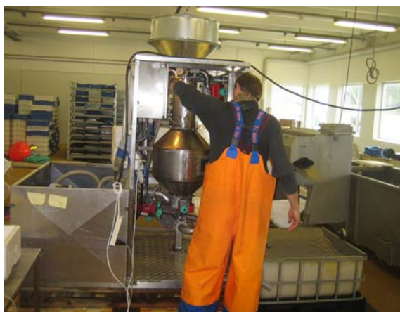
Figur 3 Vakuumutstyr for tilsetning av vann i tørrfôr fra Seafarm Products AS. Til venstre står operatøren og kontrollerer prosessen, til høyre tørrfôr etter tilsetning av vann.
