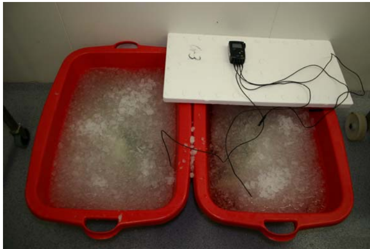
Bilde 1 Viser baljer (volum ca 50 liter) med is/ferskvanns blanding, temperatur 0 °C som ble benyttet til kjøling av fiskene i forsøk 1
