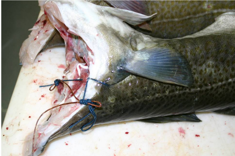
Bilde 2 Feste av ledning ved temperaturlogging i fisken mens den henger på hjell.
