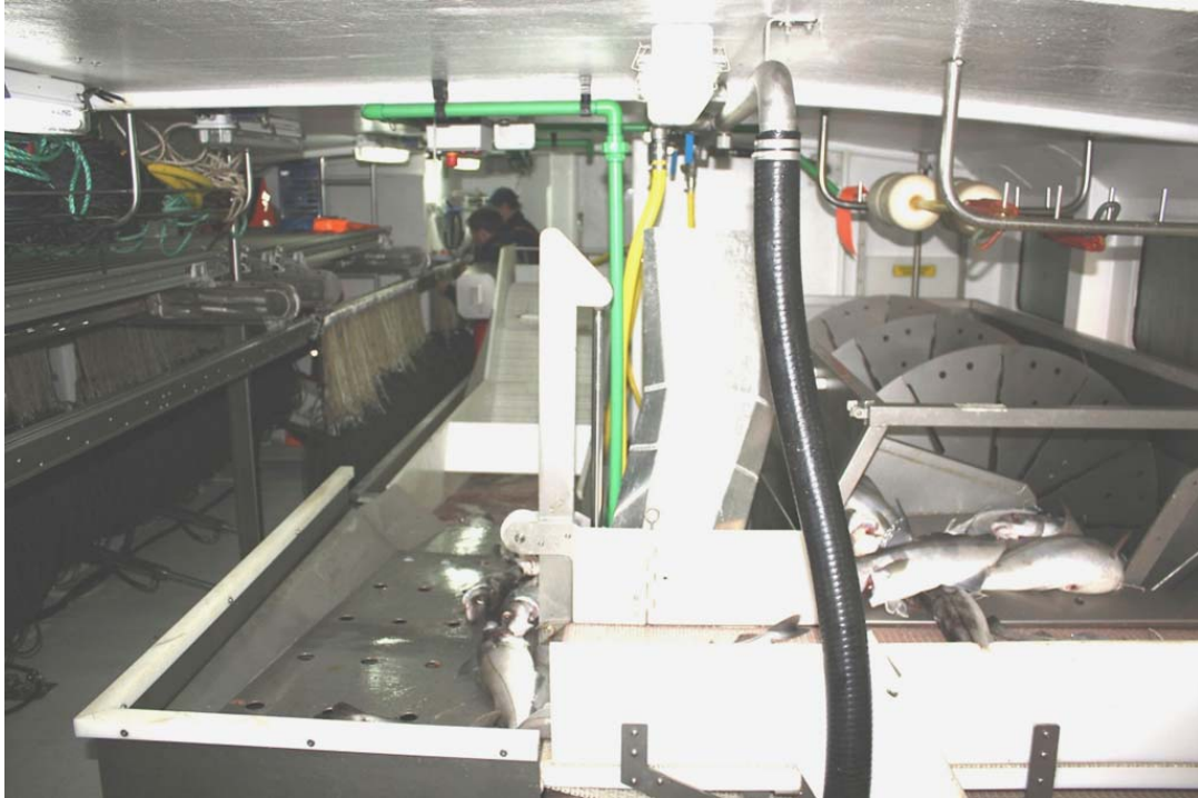
Bilde 2 Fangstbehandlingssystemet sett aktenfra. Utblødningstank til høyre. Sløyebinge, skyllekar og transportbånd til rom til høyre. Foto: Lasse Rindahl, SINTEF.
