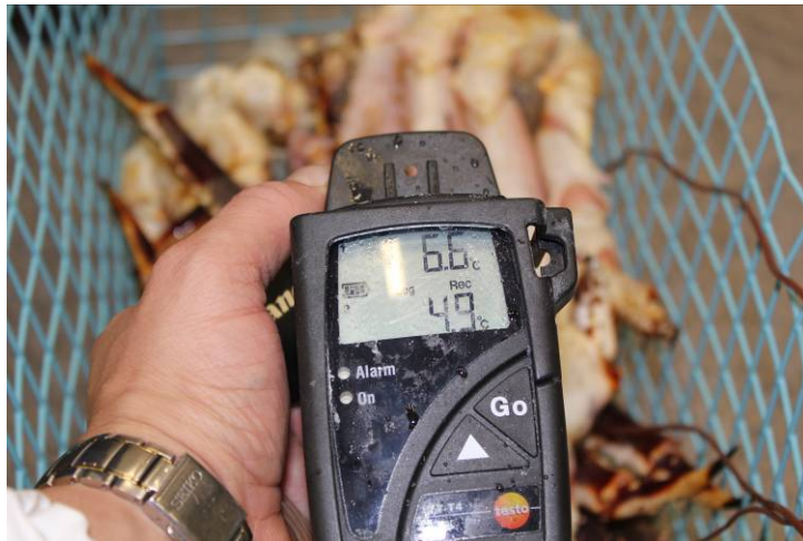
Bilde 5 Testo 177- T4 temperaturlogger.
