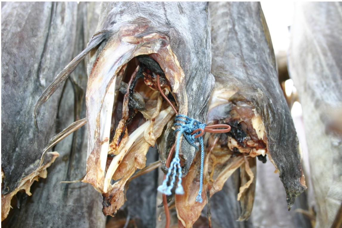
Figur 2 Bilde viser hvordan sensorledningen for logging av temperatur i muskelen er festet.
