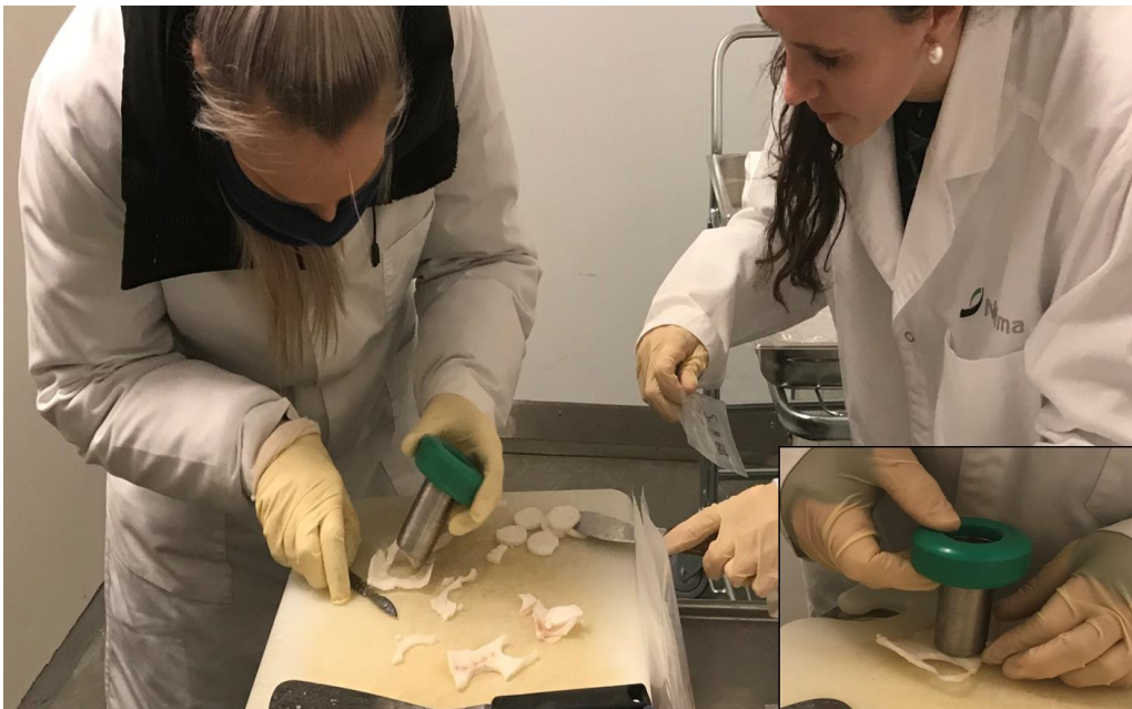
Figur 11 Tillaging av prøver til TPA og reologi (sirkler) og WHC, salt, og kjemisk analyse (rester).
