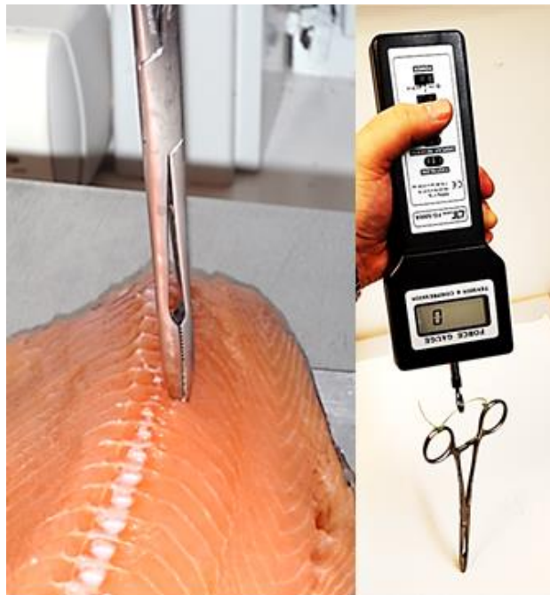
Bilde 2 Til venstre vises innfesting av en klemme til enden av pinnebeinet på laksefilet. Til høyre vises selve målearrangementet.
