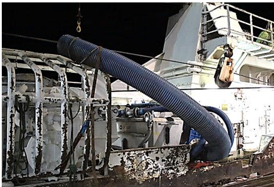
Bilde 6 Viser den fleksible vakuumslangen (Ø 350 mm) som benyttes til å tømme tanken. Hastigheten på tømmingen ble kontrollert ved å løfte og senke enden av slangen.
