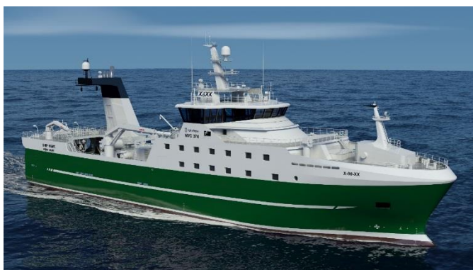
Bilde 3 Til venstre viser fartøyskisse fra Rols Royce som er basert på et standard skrog, 80 meter langt og 17 meter bredt (OPTIPRO 2). Bildet til høyre viser forslag til permanent montering/plassering av pumpeplange i codend (OPTIPRO 2).
