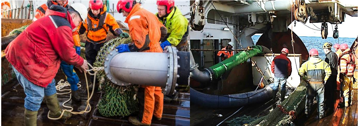
Bilde 1 Fra praktiske pumpeforsøk på M/Tr. J. Bergvoll (OPTIPRO-1 og CRISP). Skipper Torgeir Mannvik fester sekken til pumpe slang. Vakuumpumpen kunne levere 20 tonn per time (Olsen et al., 2014).
