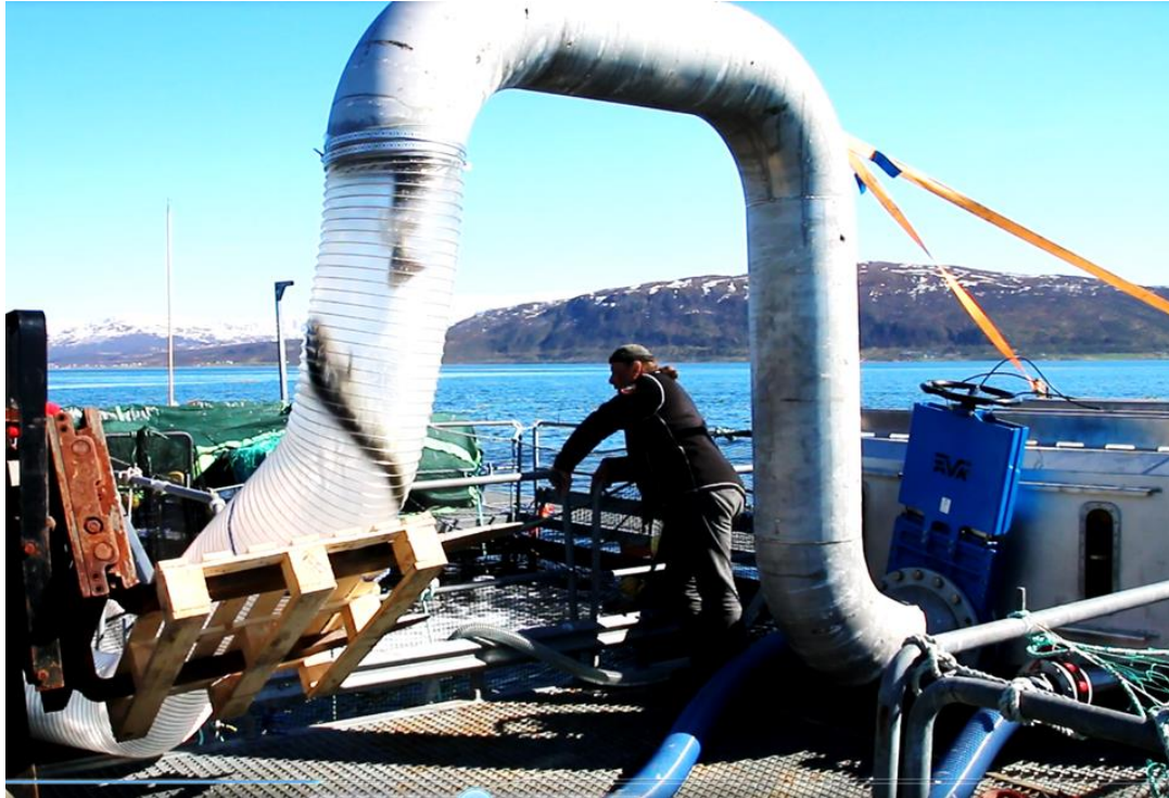
Bilde 9 Kontrollert tømning av tank ved hjelp av høy vanngjennomstrømning (2500 l/min.) via svane Halsen. En 10 meter lang polyurethane (PUH) slange med diameter på 40 cm, er påkoblet for å unngå skade og tap av fisk under tømning. Fisken blir tilbakeført til merden på en meget skånsom måte, under oppsikt av en ansatt ved Sjøanlegget.
