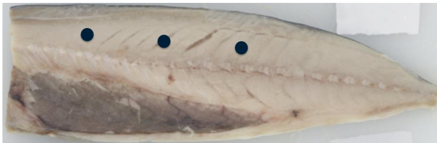
Bilde 5 De sorte prikkene viser de tre posisjonene teksturanalysen ble tatt langs filet.
