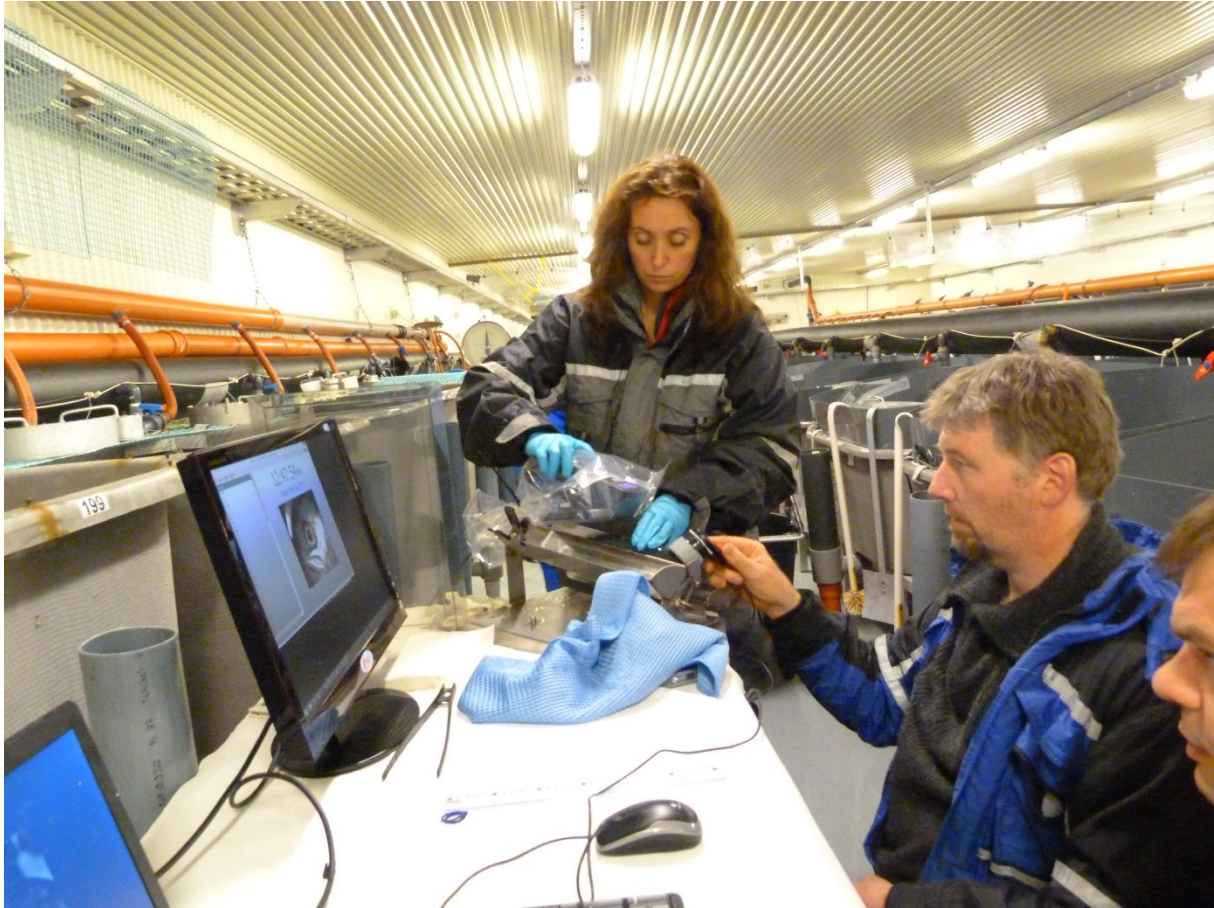
Figur 1 Bilde som viser samtidig lesing av PIT-tag og irisskanning. Laksen ligger i et stativ (slede) med åpning for hodet/øyet.
