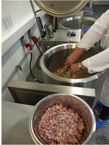
Figur 3 Temperaturen ble målt med et håndholdt termometer under produksjon av hjemmelaget lapskaus.
