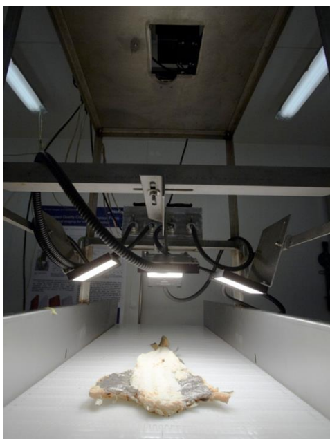
Bilde 3 Spektroskopisk måling av klippfisk (Foto: Audun Iversen, Nofima)
